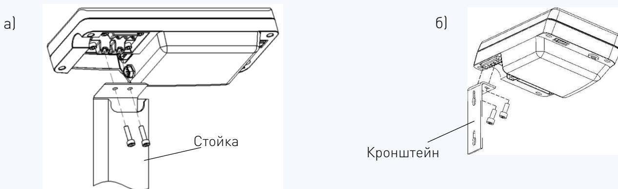
*Рис. 5.2. - Варианты крепления устройства управления*
